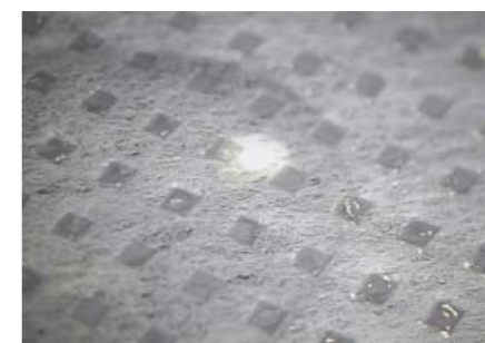
Двухслойная пароизоляционная мембрана: очень хорошее сцепление, потому что поверхностное натяжение составляет свыше 45 Н/мм 2 .
