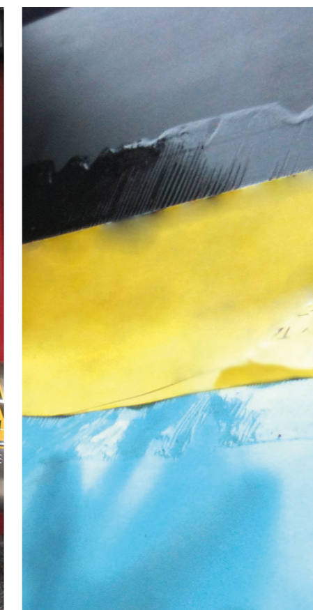
При тестировании ленты прикосновением пальца сложно сказать, какой клей лучше, так как он имеет лучшее сцепление с поверхностью пальца. На стройке это может привести к проблемам, так как мягкий клей, как правило, обладает слабыми когезионными силами.
